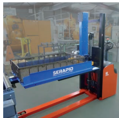
Wózek podnośnikowy do załadunku/rozładunku pieców termicznych
