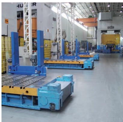
System pchająco-ciągący (PPS) do pozycjonowania narzędzia zainstalowany na pojazdach zintegrowanych z prasami klienta
