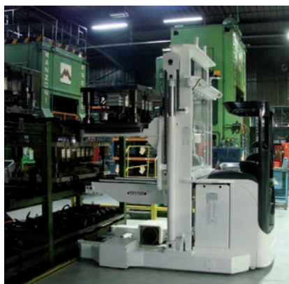
Wózek narzędziowy z podwójną platformą załadunku/rozładunku obsługiwany przez operatora
