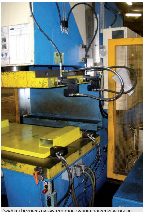
Szybki i bezpieczny system mocowania narzędzi w prasie
