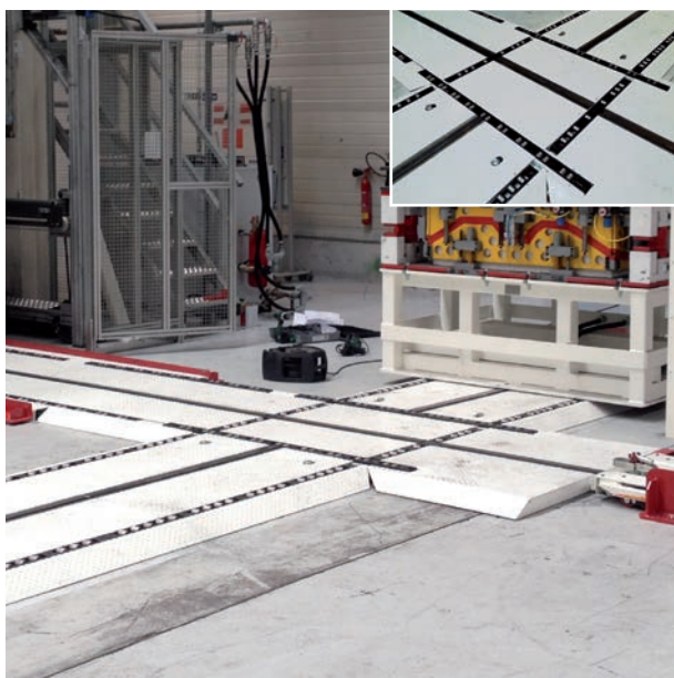
Urządzenie do szybkiej wymiany narzędzi przy wykorzystaniu elementów rolkowych
