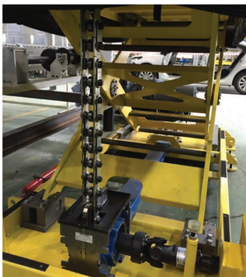
Platforma podnosząca, przemysł motoryzacyjny: podnośnik łańcuchowy HD Lift 60S
